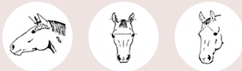
Figur 5a, 5b och 5c. Häst: Skottet placeras mitt emellan en tänkt linje mellan överkanten på ögonen och översta benkanten i skallen (figur 5a och 5b). Placeringen blir i regel cirka 2 cm ovanför den punkt där tänkta linjer från respektive öra till motstående sidas öga korsas, nära det främre pannluggsfästet (figur 5c).
